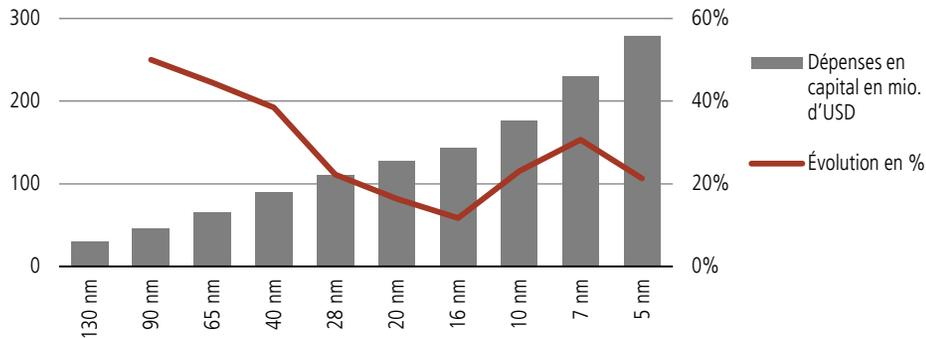
Remarque : L'industrie produit actuellement une technologie à 20 nm, 16 nm et 14 nm. Les prochains niveaux sont 10 nm et 7 nm et les investissements requis à cette fin sont considérables.
